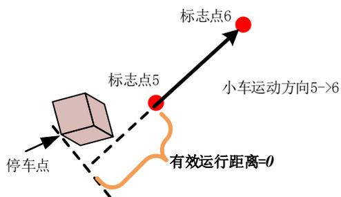
图 4 电动车逆向运行的距离测量
