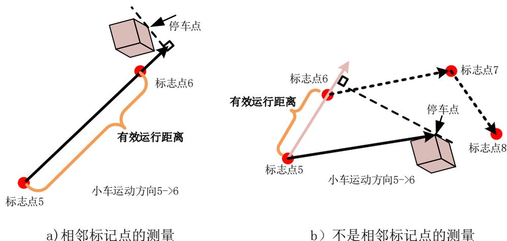
图 3 电动车运行超过标记点的距离测量
